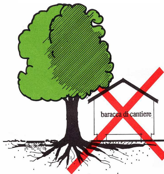
Fig. 5 – Aerazione delle radici.
